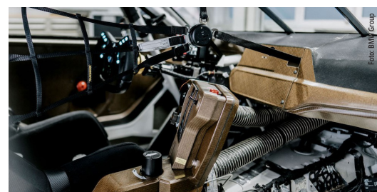
Naturfaser Komponenten im Cockpit
